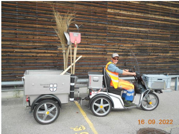
Abb. 1: Bei den Kyburz Dreirädern handelt es sich um wiederaufbereitete ehemalige Fahrzeuge der Post mit neuen Akkus. Als Alternative zum gefährlichen Mitfahren auf dem Trittbrett eines Anhängers haben sie sich in der Praxis sehr bewährt.
