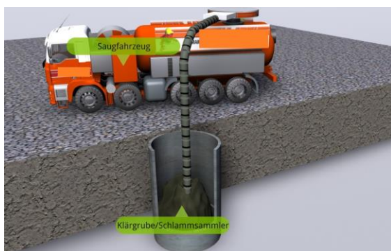
Abb. 1: Systembild Reinigung Schlammfänger
