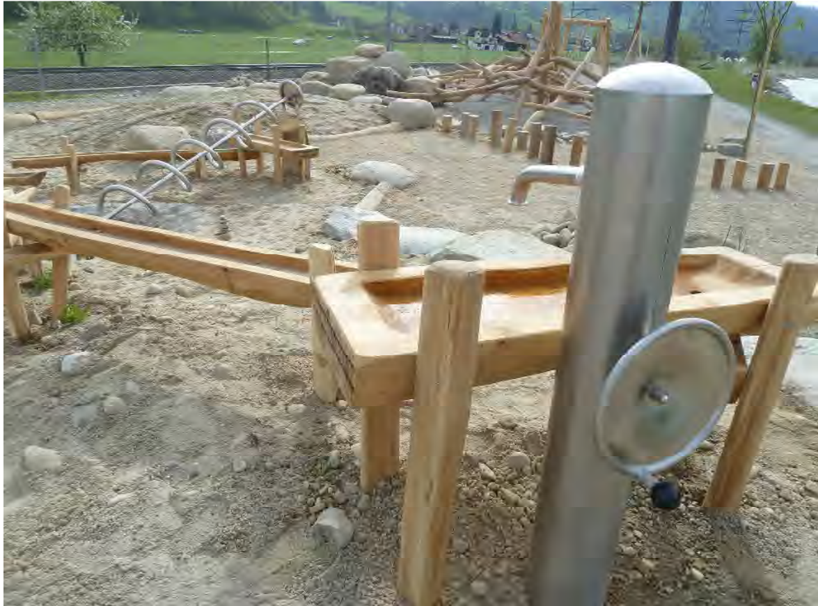
8 Handrad-Pumpe mit Wasserrinne
